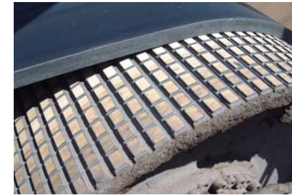
Forro de fricción CERASINT sobre tambor de reenvío
